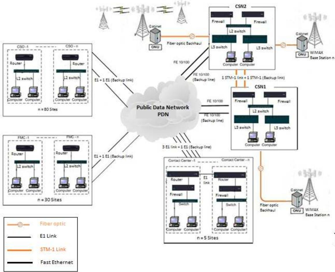
الشكل (10.2): الترابط الشبكي بين عناصر ومكونات شبكة WiMAX في سوريا، وفق التصور للمشروع المقترح
