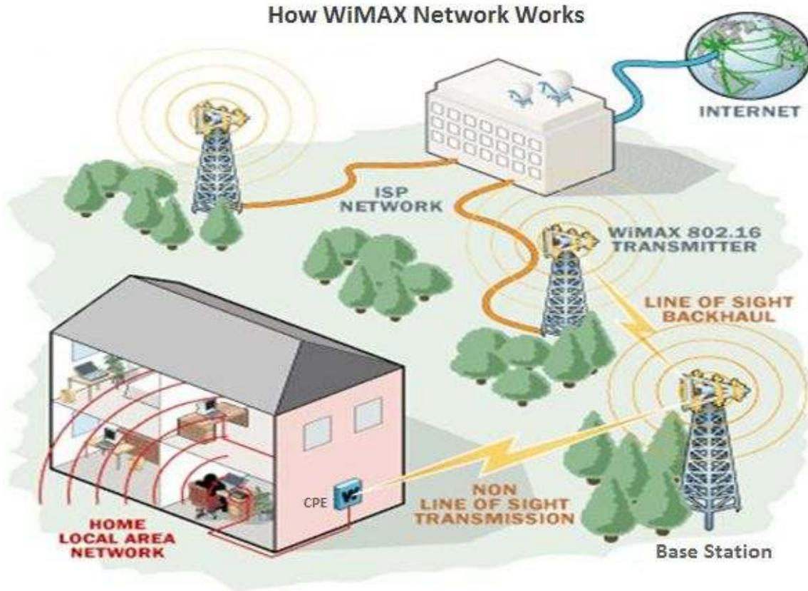
الشكل (6.1): العناصر الأساسية لشبكة WiMAX وطريقة عملها
